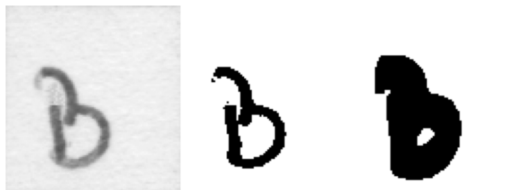
Slika 2.10: Prikaz više prolaza algoritma dilatacije
