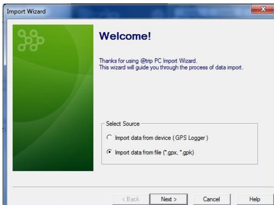
Slika 20. Učitavanje ruta iz .gpx/.gpk datoteke
